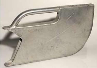
FIGURE 2.9 – ELLIS CUP SAMPLER
