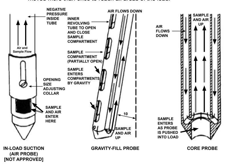
Figure 3. Probe-Type Samplers
