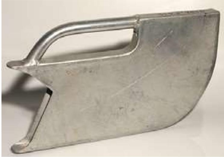
**FIGURE 2.9 – ELLIS CUP SAMPLER**
